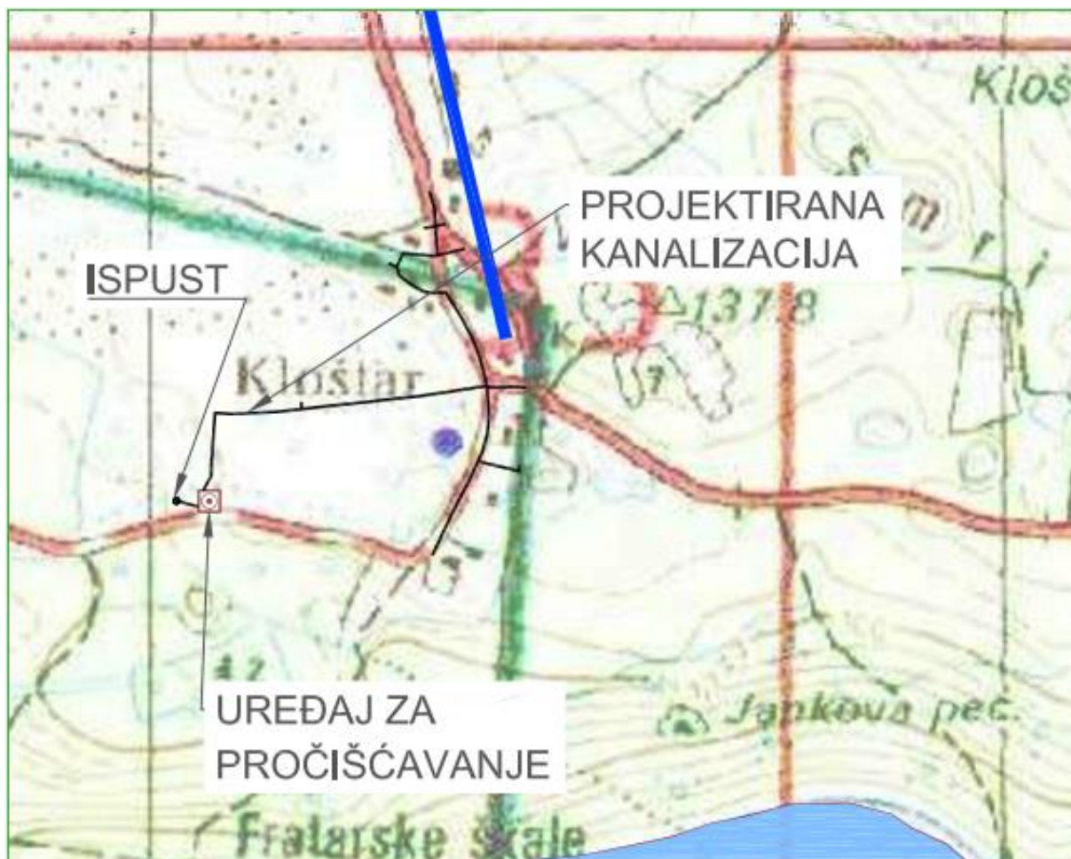
Slika 20: Prikaz kanalizacijskog sustava Kloštar na Izvatku iz kartografskog prikaza br. 2. „Infrastrukturni sustavi i mreže“
